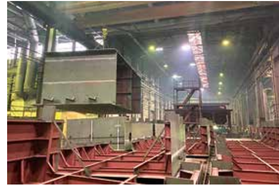
Линия стыковки секций баржи на стапеле / Фото: ООО «Самусьский судостроительно-судоремонтный завод»
