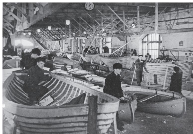
На заводе с 1920-х действовал деревообделочный цех, который занимался изготовлением шлюпок и лодок
