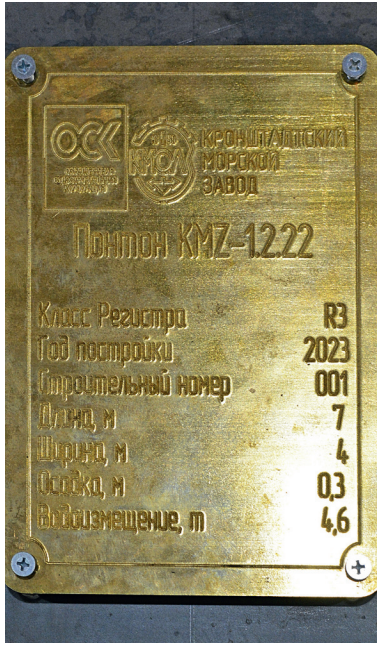
Длина понтона составляет 7 м, ширина – 4 м. Водоизмещение – 4,6 т.
