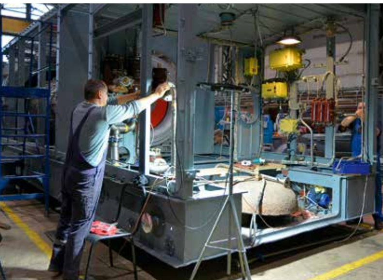
Сборка ГПА в блоке / Фото: Корабел.ру
