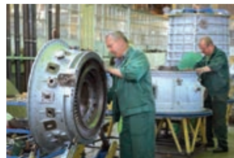
Завод выполняет полный цикл среднего ремонта газотурбинных двигателей для кораблей отечественного флота
