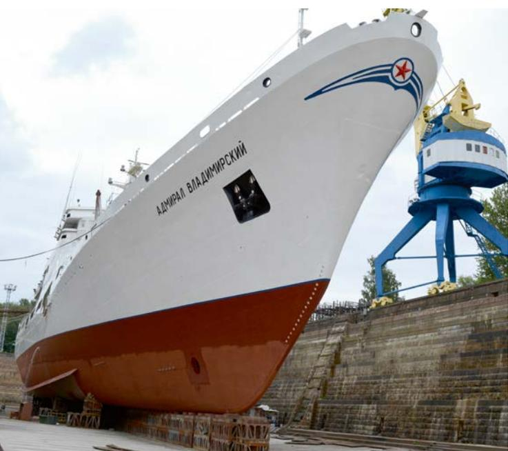
ной арматуры, винто-рулевой группы и ряда других работ, были тщательно восстановлены изношенные части клепаного корпуса. Ведь аутентичный корпус старинного ледокола скреплен пятью тысячами заклепок!
